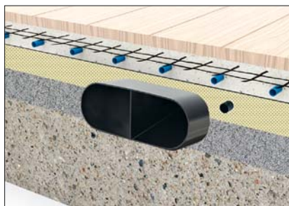
Ploché potrubí částečně ve vyrovnávací vrstvě a v mazanině s výztuží
